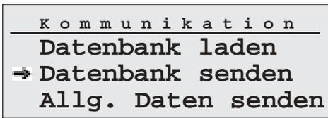
Am ecom-JN wählen Sie die Funktion "Datenbank senden" und betätigen die Taste <E>. Die Daten werden an den PC übertragen. In der Datenbank der RAM-Karte des ecom-JN befinden sich Informationen über die erfolgten Änderungen. Das bedeutet, dass nur die Datensätze übertragen werden, zu denen auch Messungen abgelegt wurden.
