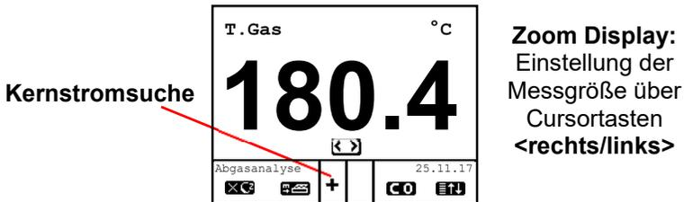
Eine Trendanzeige für T.Gas erleichtert die Kernstromsuche. Solange im Display ein Plus-Zeichen erscheint, steigt die gemessene Temperatur, d.h. die Sondenspitze bewegt sich in Richtung des Zentrums des Kernstromes. Erscheint ein Minus-Zeichen im Display, bewegen Sie die Sonde aus dem Kernstrom heraus und die Temperatur sinkt. Erfolgt für mindestens 3 Sekunden keine Änderung der Temperatur mehr, erlischt die Trendanzeige.
