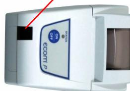
Bitte beachten Sie, dass zwischen der Sendediode und der Empfangsdiode am Drucker eine störungsfreie Verbindung (direkte Sicht) besteht. Die Entfernung zwischen beiden Geräten sollte nicht mehr als ca. 40 cm betragen, da ansonsten eine störungsfreie Übertragung nicht in jedem Fall gegeben ist.
