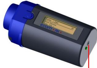
Kabelverbindung zum AUX-Anschluss
