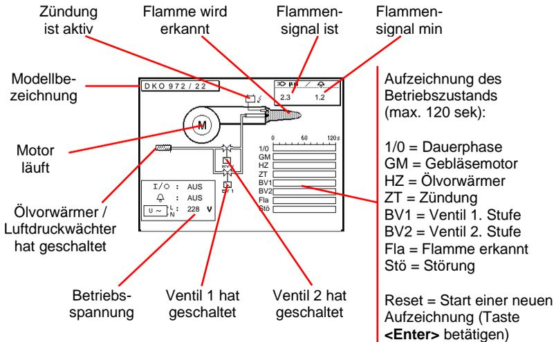
Mit Cursor-Tasten (hoch/runter) lassen sich weitere Informationen des Feuerungsautomaten abrufen. Auf der 2. Displayseite wird der aktuelle Fehler und die Anzahl der Brennerstarts dargestellt
