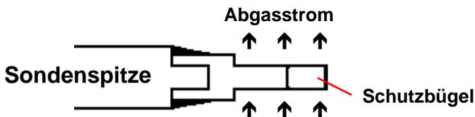
Führen Sie die Messung im Kernstrom des Abgaskanals durch (Sondenposition mit der höchsten Abgastemperatur). Eine Trendanzeige für T.Gas erleichtert die Kernstromsuche. Solange im Display ein Pfeil nach oben erscheint, steigt die gemessene Temperatur, d.h. die Sondenspitze bewegt sich in Richtung des Zentrums des Kernstromes. Erscheint ein Pfeil nach unten im Display, bewegen Sie die Sonde aus dem Kernstrom heraus und die Temperatur sinkt.
