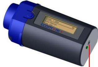
Kabelverbindung zum AUX-Anschluss
