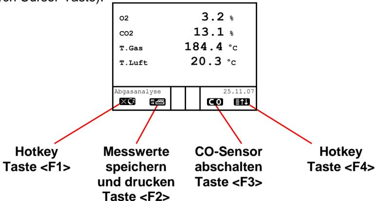
Mit <F1> kann aus der Messwertanzeige zu einem zuvor ausgewählten Menüpunkt oder eine Funktion (siehe Kapitel Einstellungen) geschaltet werden. Mögliche Einstellungen sind: Ruß...Ölderivat, Datenverarbeitung, Einstellungen, Kontrolle, Brennstoffart, Standby, Spülen, Eta (K), Speicher -> M, CLD NO <-> NOx, WLAN, Zug/dP. Weiterhin kann von jedem beliebigem Menüpunkt mit <F1> zur Messwertanzeige geschaltet werden.
