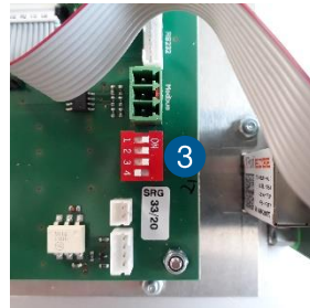
1 Rändelschraube 2 Frontplatte 3 DIP Schalter
