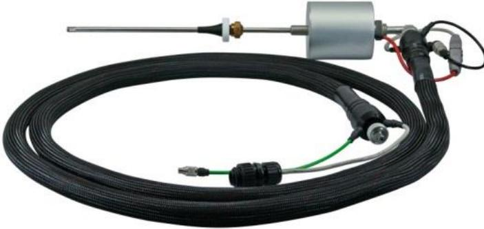
Durch Verwendung des beheizten Entnahmesystems ist die Messung wasserlöslicher Zielsubstanzen ( $\text{NO}_2$  und  $\text{SO}_2$ ) ohne Auswaschverluste möglich. Sondenkopf und Entnahmeschlauch werden auf  $140\text{ }^\circ\text{C}$  beheizt. Ein im Sondenkopf integrierter PTFE Filter schützt das Gerät insbesondere bei Langzeitmessungen vor Verschmutzung. Die maximal zulässige Abgastemperatur bei Verwendung des beheizten Entnahmesystems beträgt  $500\text{ }^\circ\text{C}$ .
