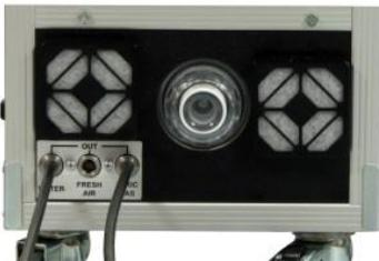
Schrauben Sie die Abdeckkappe ab und kontrollieren Sie den Zustand des Filters. Er sollte gewechselt werden, wenn der Filter (außen) grau gefärbt ist (Grauwert der Rußskala ca. 2 - 3).
