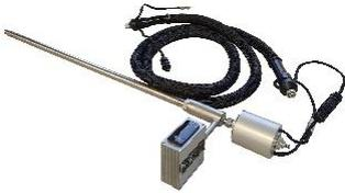
Das beheizte Entnahmerohr hat einen Durchmesser von 25 mm und ist 1 m lang. Die Spannungsversorgung für die Beheizung wird durch ein 4 m langes Anschlusskabel sichergestellt. Die Temperaturregelung ist in dem angebauten Anschlusskasten untergebracht. Die Temperatur kann zwischen 100 °C und 180 °C eingestellt werden. Die maximale Abgastemperatur für den Einsatz des beheizten Entnahmerohrs beträgt 400 °C.
