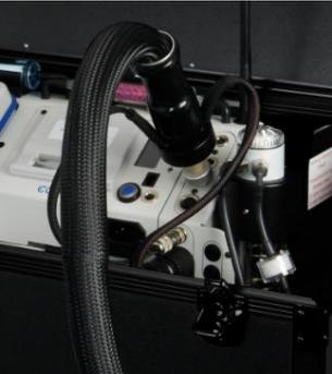
Das beheizte Entnahmesystem kann in Kombination mit dem ecom-J2KNpro tech genutzt werden. Dazu wird der beheizte Schlauch, wie in dem Bild dargestellt, angeschlossen.
