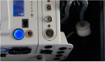
Kontrollieren Sie den Zustand des Sicherheitsfilters. Er sollte gewechselt werden, wenn der Filter grau gefärbt ist (Grauwert der Rußskala ca. 2 - 3).
