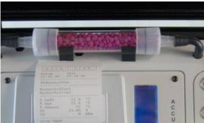
An der Geräteoberseite befindet sich im Gasweg des elektrochemischen CO-Sensors ein chemischer Filter für die Ausfilterung von SO<sub>2</sub>- und NO<sub>x</sub>-Bestandteilen im Messgas. Der Filter ist zu wechseln, wenn der Farbumschlag auf grau erfolgt ist (Farbwechsel erfolgt in den Stufen: pink = Originalzustand > braun > schwarz > grau > weiß).
