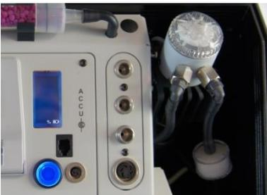
Schrauben Sie die Abdeckkappe ab und kontrollieren Sie den Zustand des Feinstaubfilters. Er sollte gewechselt werden, wenn der Filter grau gefärbt ist (Grauwert der Rußskala ca. 2 - 3).
