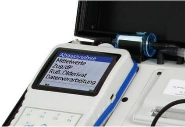
Kontrollieren Sie den Zustand des Filters. Er sollte gewechselt werden, wenn der Filter (außen) grau gefärbt ist (Grauwert der Rußskala ca. 2 - 3).
