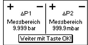
Nach dem Einschalten des Gerätes werden Bezeichnungen und Messbereiche der Drucksensoren eingeblendet. Durch Betätigung der <OK>-Taste kann zur Messwertanzeige geschaltet werden.
