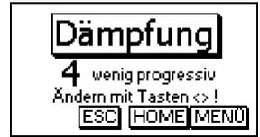
Zum Ändern der Einstellung blättern Sie mit den Cursor-tasten **<hoch/runter>** bis zum Menüpunkt „Dämpfung“. Aktivieren Sie den Menüpunkt durch die **<OK>**-Taste. Mit den Cursor-tasten **<rechts/links>** kann die gewünschte Dämpfung eingestellt werden. Eine Änderung der Einstellung muss mit der **<OK>**-Taste bestätigt werden.
